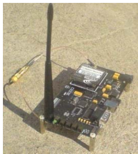
Figura 16. Modelo de interfaz inalámbrica propuesto por (Pérez Ramos, 2008) que incluye el módulo de comunicación AeroComm AC4790-1000.
