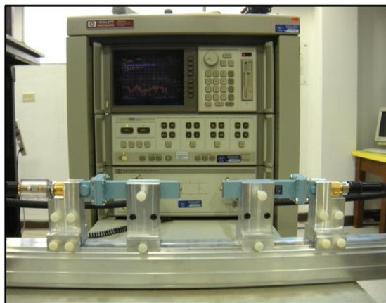
**Figura 29. Conexión con las cargas “match”.**
