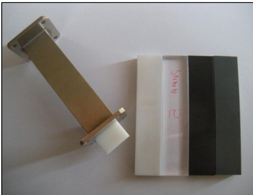
**Figura 17. Guía de onda de sección recta para la banda X y algunas muestras.**
