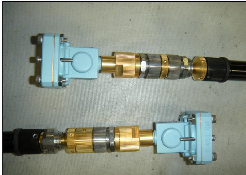
**Figura 95. Conexión en corto "short".**
