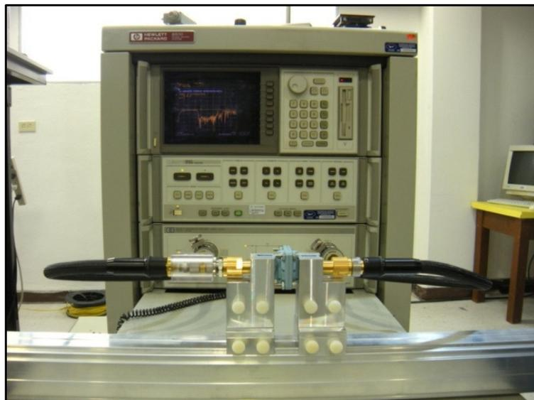
**Figura 27. Conexión thru.**
