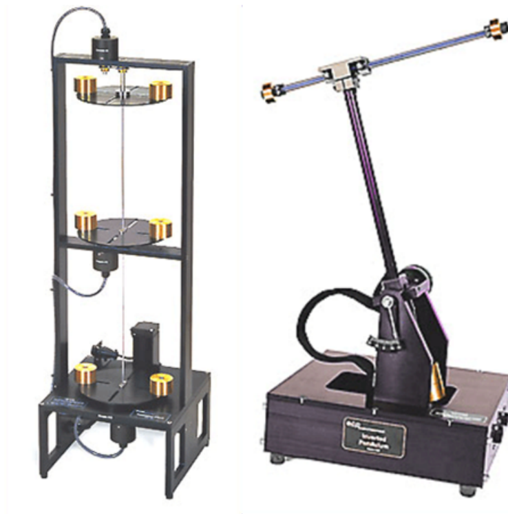
Figura 48. Sistema torsional ECP modelo 205 y péndulo invertido ECP modelo 505.
