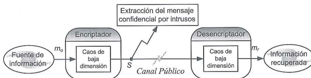
Figura 5: En algunos sistemas criptográficos y en situaciones particulares, un intruso pudo extraer el mensaje oculto en el caos, empleando técnicas de procesamiento de señales o mapas de regresión.
