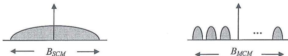
**Figura 5.** Ancho de banda requerido por la técnica de modulación (a) SCM y (b) MCM.
