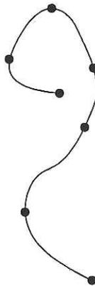
Figura 16: Conjunto de siete puntos de control que se interpolan con secciones polinómicas continuas en el sentido de la pieza.
