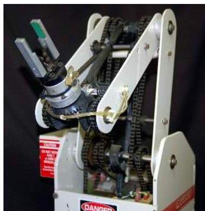
Figura 28. Transmisión mediante cadenas y engranajes del manipulador Pegasus .
