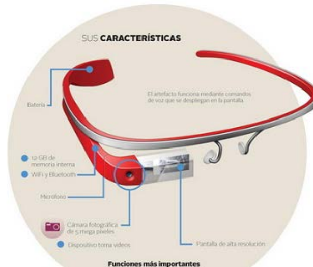
Figura 31. Partes esenciales del Google Glass.
