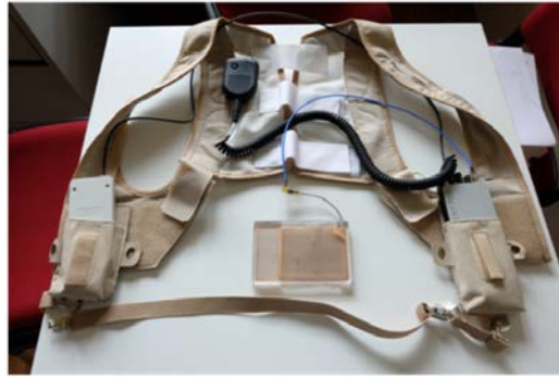
Figura 8. Antena TETRA montada en chaleco con radio Polycomm.
