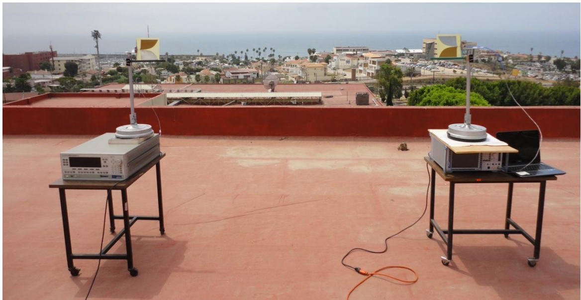
Figura 80. Configuración de los equipos para la medición del patrón de radiación de las antenas.
