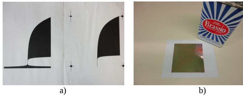
Figura 64. Preparación del sustrato, a) Impresión de alta resolución, b) Substrato perfectamente limpio.
