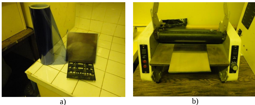
Figura 66. Procesos de aplicación de la filmina, a) Filmina puesta con rodillo, b) Adherencia de la filmina en la roladora térmica.
