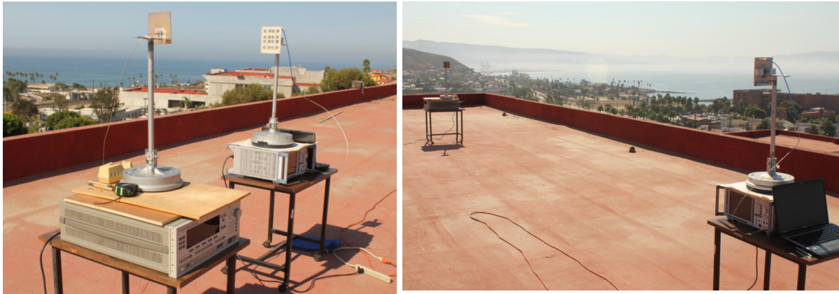
Figura 72. Procedimiento de medición del patrón de radiación.
