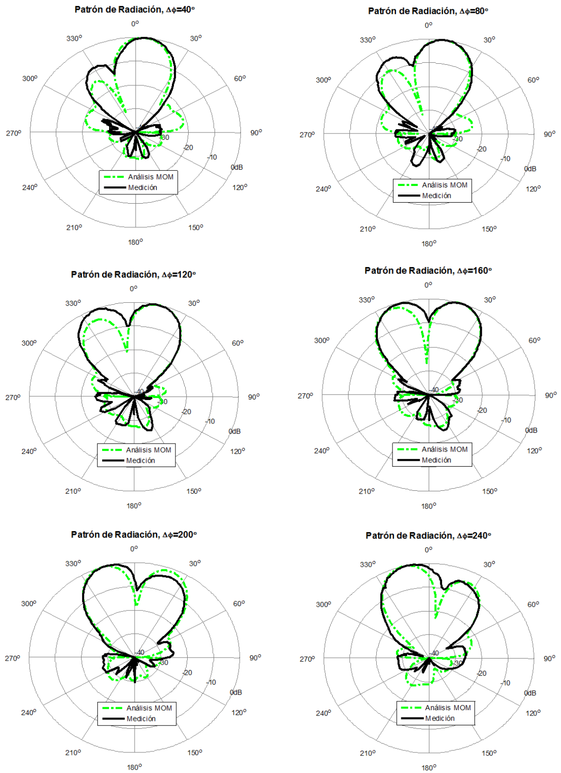
Figura 77. Patrones de radiación en gráfica polar: medición vs análisis EM, parte 2.
