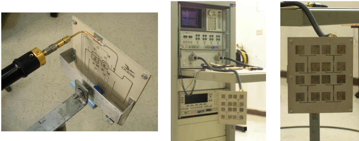
Figura 68. Medición de las pérdidas por retorno de la antena desarrollada.
