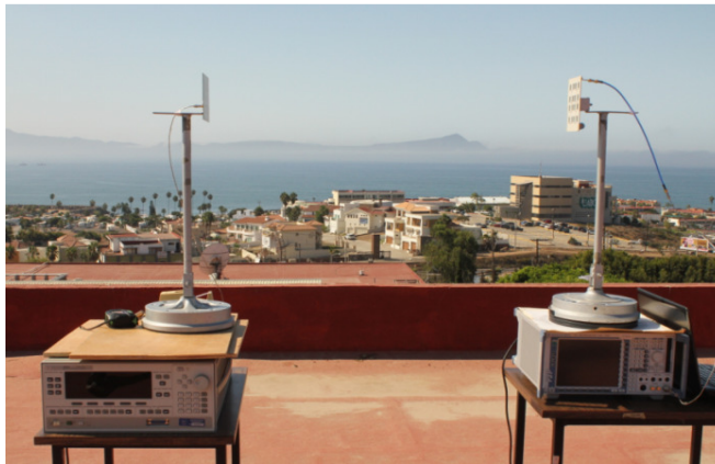
Figura 71. Medición de la ganancia de las antenas usando un analizador de espectros.
