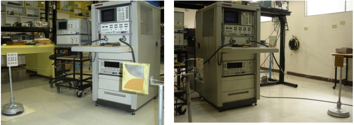
Figura 69. Medición de la ganancia de las antenas mediante el analizador de redes.
