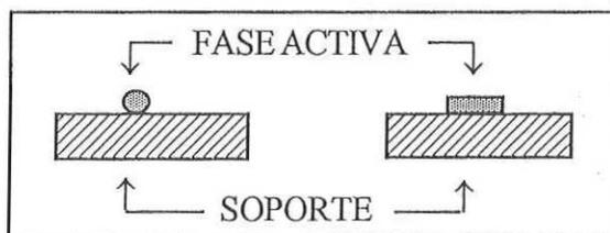
Figura 2. Diagrama que muestra la interacción de la fase activa con el soporte. En el recuadro se muestran las posibles formas de las partículas del catalizador (Niemantsverdriet, 1995).
