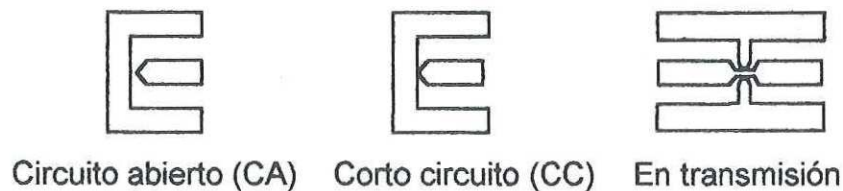
Figura 21. Línea de acceso al transistor cargada con un corto circuito (CC),
