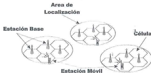
Figura 1. Estructura de una red celular
