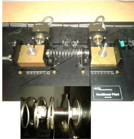
Figura 40. Plataforma experimental ECP-210 modificada para tener una restricción de fuerza.
