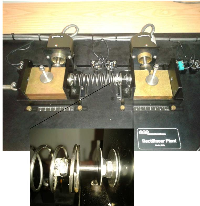
Figura 11. Plataforma masa-resorte de la compañía Educational Control Products (ECP-210) configurada para tener una restricción unilateral.
