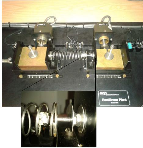
Figura 44. Plataforma experimental ECP-210 modificada para tener una restricción de posición.
