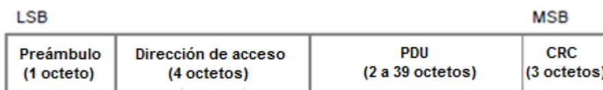
*Figura 18. Formato de paquete LLDU en Bluetooth Low Energy*
