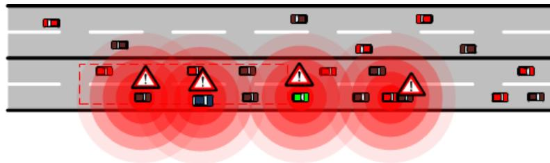
Figura 7. Diseminación de un mensaje *broadcast* para indicar que ha ocurrido un accidente, ejemplo de una aplicación habilitada por un protocolo de difusión *broadcast*.
