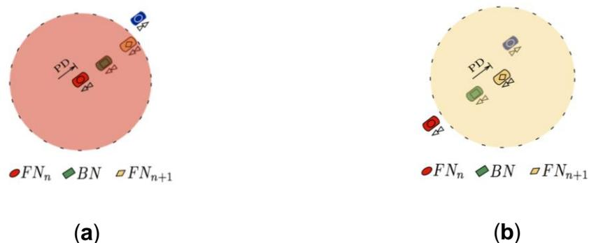
Figura 11. Ejemplo del mecanismo de acuse de recibo implícito implementado en FPBR. (a) El retransmisor primario recibe exitosamente el paquete de descubrimiento; (b) El nodo BN recibe exitosamente el acuse de recibo implícito proveniente de  $FN_{n+1}$ .
