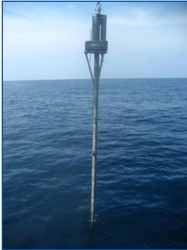
Figura 7. Sonda para medir el flujo de calor en ambientes marinos.
