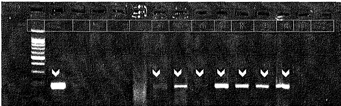
Figura 15. Electroforesis en gel de agarosa [2%] para identificación del gen O1 (Fragmento esperado 192 pb) presente en V. cholerae medio APA. Muestreo Bahía San Ignacio, Mayo (1: Escalera 100 pb, 2: V. cholerae CICESE 82, 3: Dilución 0.1-réplica 1, 4: Dilución 0.1-réplica 2, 5: Dilución 0.1-réplica 3, 6: Dilución 0.01-réplica 1, 7: Dilución 0.01-réplica 2, 8: Dilución 0.01-réplica 3, 9: Dilución 0.001-réplica 1, 10: Dilución 0.001-réplica 2, 11: Dilución 0.001-réplica 3, 12: Blanco). ▽ = Positivo.
