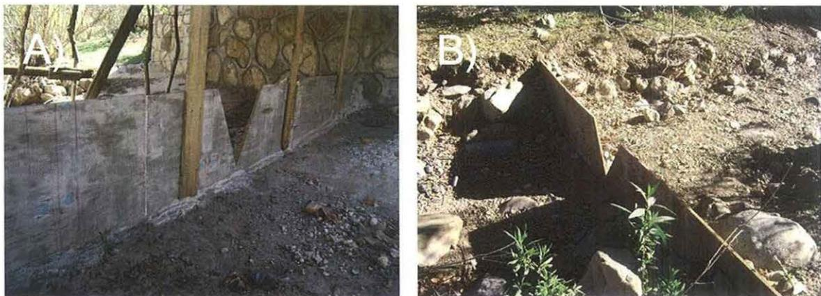
Figura 14. Vertedores triangulares de pared delgada. Vertedor I (A), Vertedor II (B).
