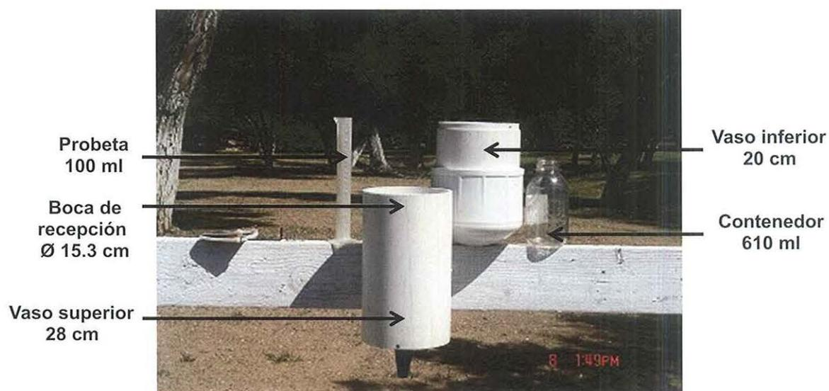
Figura 11. Pluviómetro casero utilizado dentro de la subcuenca El Mogor.
