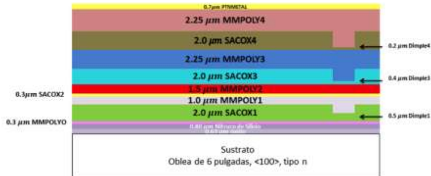
Figura 71. Capas utilizadas en el proceso SUMMiT V.
