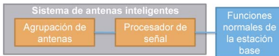
Figura 1. Bloques que conforman los sistemas de antenas inteligentes empleados en las comunicaciones móviles celulares.
