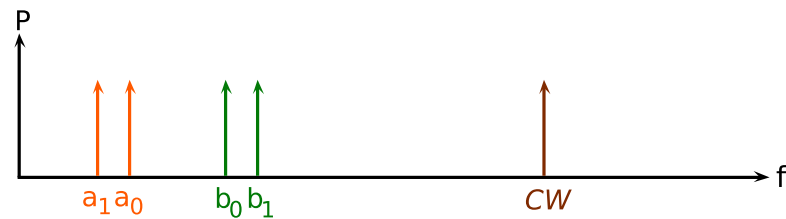
Figura 16. Espectro de entrada para multiplicar dos palabras de dos bits.
