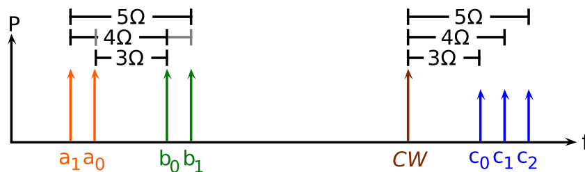
Figura 17. Frecuencias de desacuerdo entre los bits de las palabras de entrada y los bits de la palabra de salida para el caso de la multiplicación de dos palabras de dos bits.
