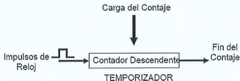
*Figura28: Esquema simplificado de un temporizador.*
