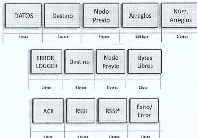
**Figura27: Formato de los mensajes de DATOS, ERROR\_LOGGER y ACK en el protocolo de enrutamiento M a M.**
