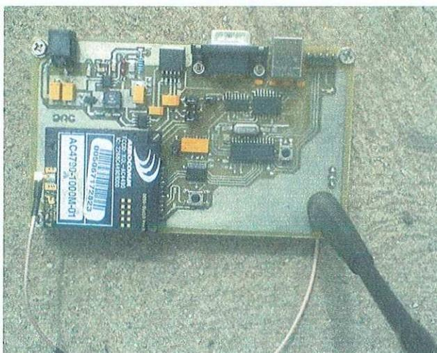
**Figura13. : Implementación del segundo modelo de Interfaz Inalámbrica.**
