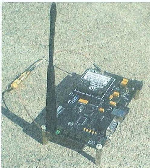
**Figura14. : Implementación del tercer modelo de Interfaz Inalámbrica.**
