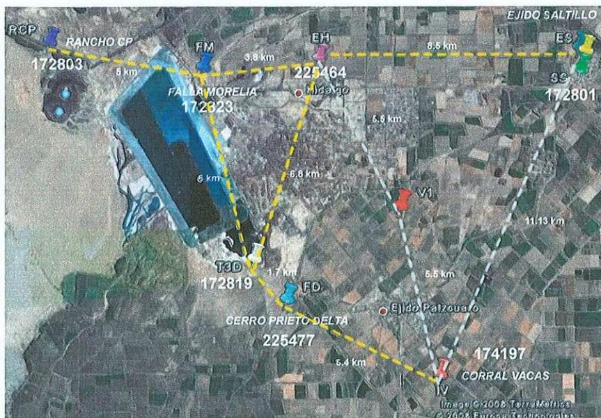
**Figura39: Ubicación, identificación y distancia entre nodos en la que será la Red Inalámbrica de Sensores de Deformación del Valle de Mexicali (RISDEFVM)**
