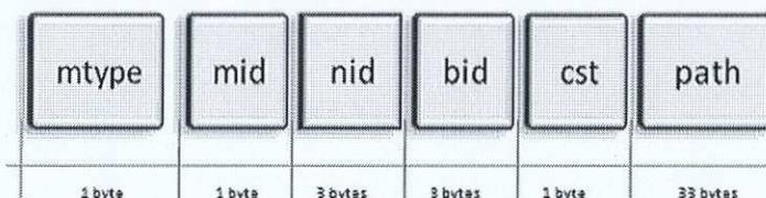
Figura16: Formato del mensaje RPRI en el protocolo de enrutamiento M a 1.
