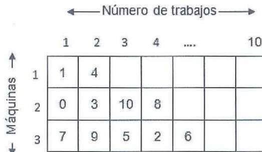
Figura 4. Representación de un individuo (cromosoma) en dos dimensiones con 11 trabajos.
