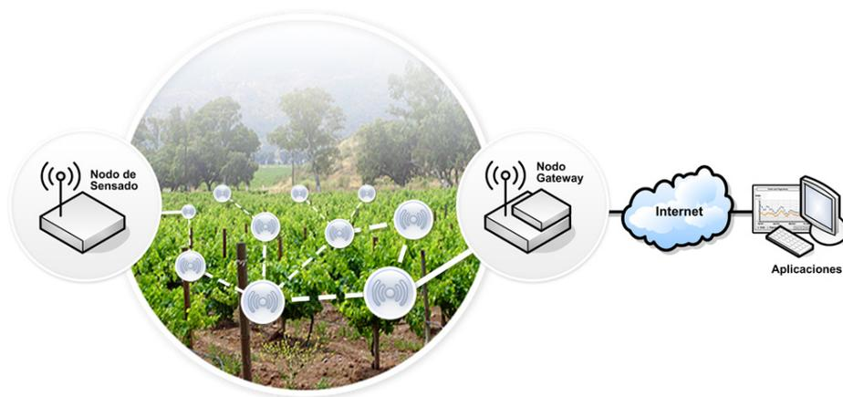
Figura 3: **Arquitectura típica de una red inalámbrica de sensores**
