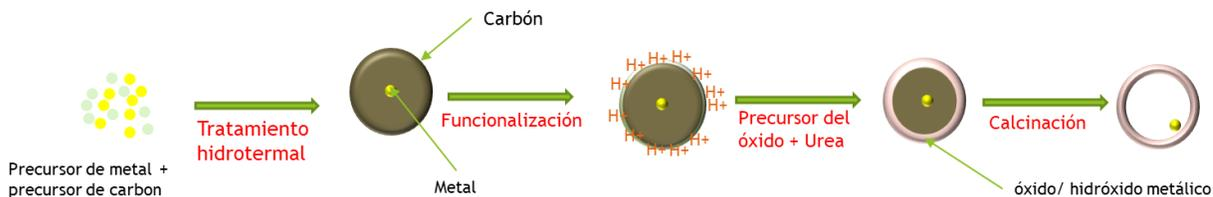
Figura 16. Método de síntesis de nanorreactores a partir de Au NPs encapsuladas en carbón (Z. Wang et al., 2014).
