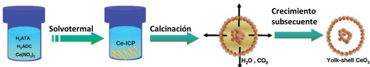
Figura 12. Síntesis en condiciones hidrotermales de nanoesferas tipo yolk-shell de  $\text{CeO}_2$  (C.-M. Fan et al., 2012).
