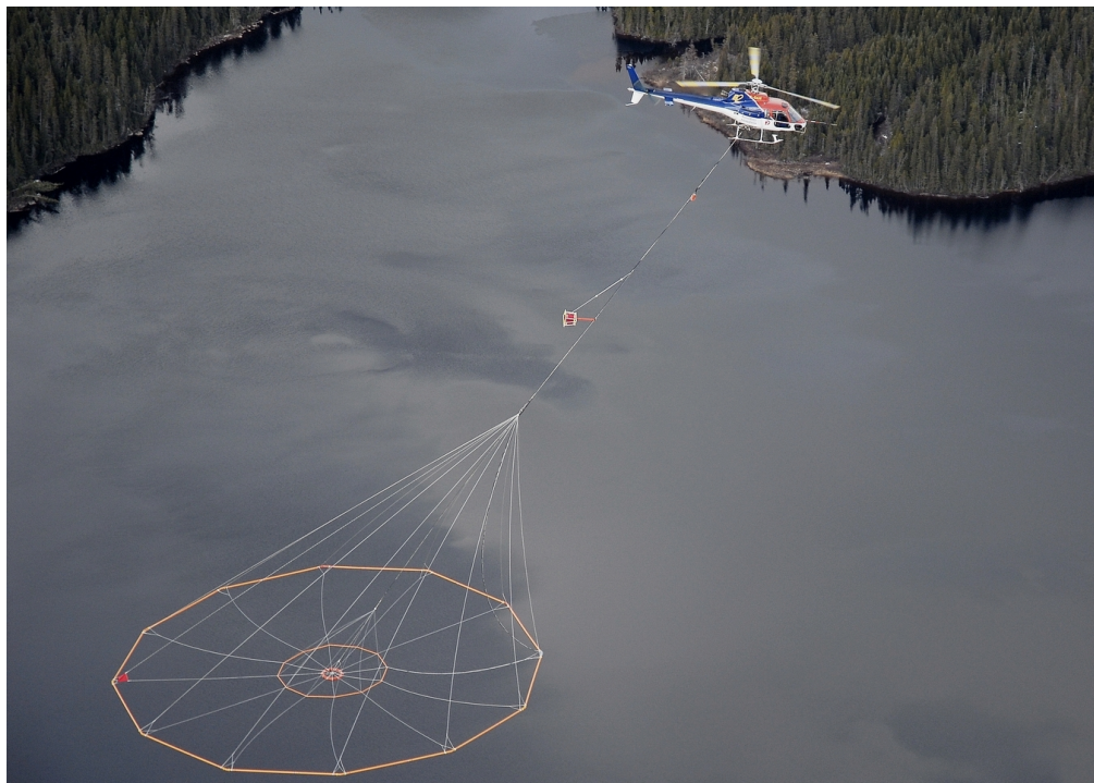
Figura 15. Sistema electromagnético versátil en el dominio del tiempo por sus siglas en inglés VTEM (tomado de Geotech http://geotech.ca ).
