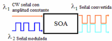
Figura 3. El principio de operación de un convertidor de longitud de onda basado en la XGM.
