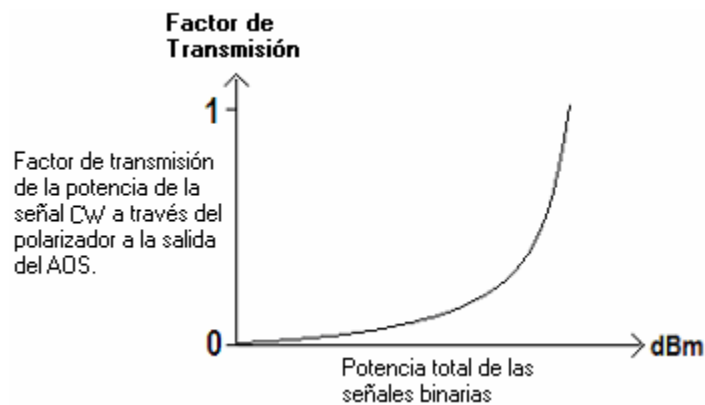
Figura 19. Relación entre la potencia total de las señales binarias y el factor de transmisión de potencia de la señal CW provocado por la XPolM y el polarizador colocado a la salida del AOS.
