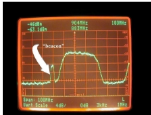
Figura 45. Identificación del "beacon" dentro del espectro recibido.
