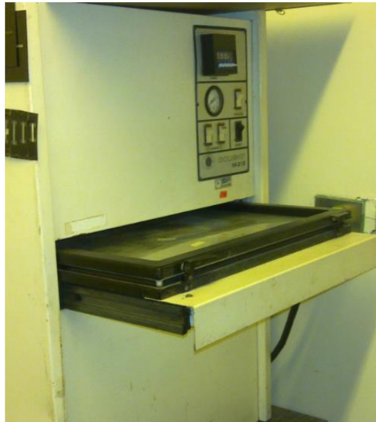
Figura 53. Maquina Colight M-218 para exponer a la luz ultravioleta.
