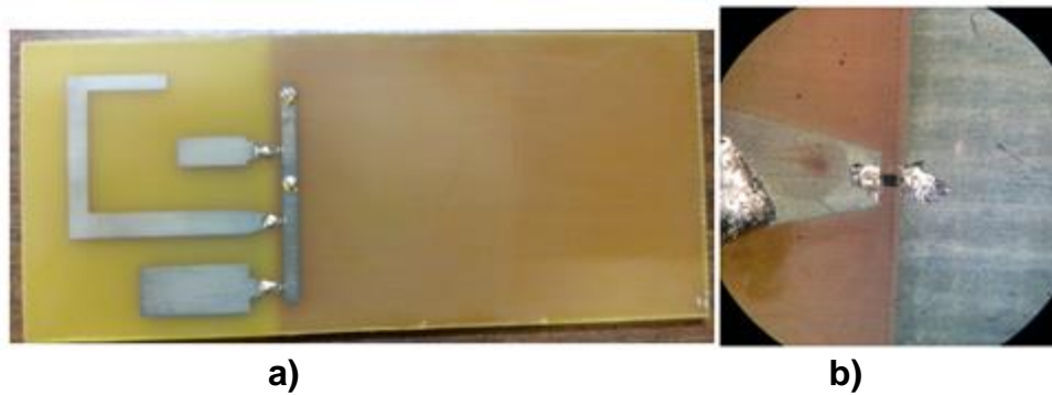
Figura 63. Montaje de los diodos PIN en la antena (a) y un acercamiento al microscopio (b).
