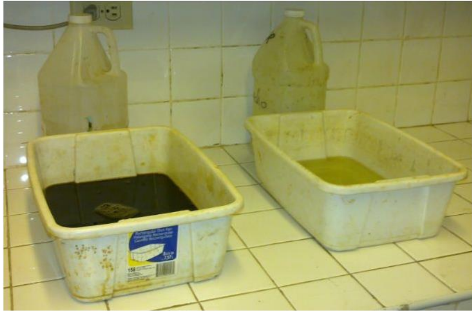
Figura 54 Revelador de filmína y Cloruro Férrico para obtener el circuito.
