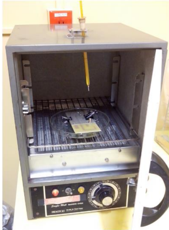
Figura 59. Circuitos introducidos al horno para secar el Epoxy conductivo.
