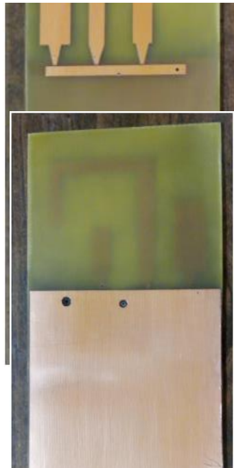
Figura 55. Circuito impreso de la antena y su plano de tierra.
