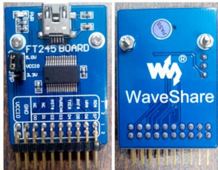
Figura 65. Circuito de control FT245RL (USB - puerto serie).
