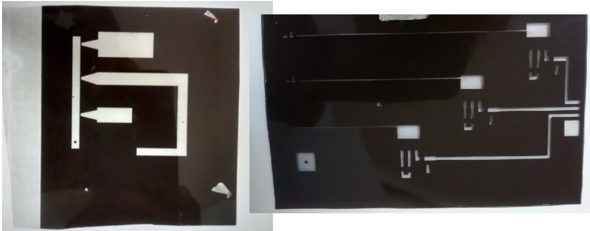
Figura 51. Mascarillas de la antena en película de alta resolución.
