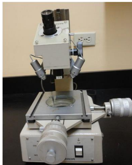
Figura 50. Microscopio Mitutoyo utilizado para verificar las dimensiones de la mascarilla.
