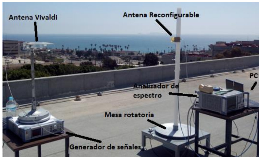
Figura 82: Configuración de los equipos para medir el patrón de radiación de las antenas.
