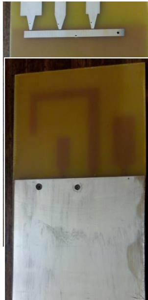
Figura 57. Circuitos de la antena y su plano de tierra protegidos con níquel.
