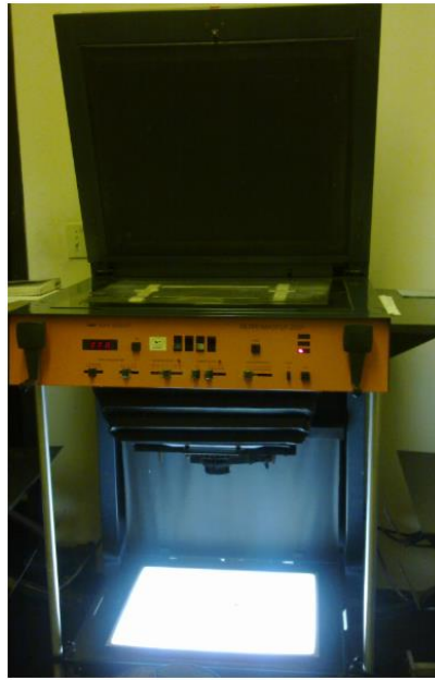
Figura 49. Máquina Repromaster Agfa para obtener la mascarilla de la antena.
