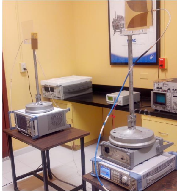
Figura 78. Equipo utilizado en la medición de la ganancia de la antena reconfigurable.
