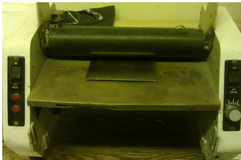
Figura 52. Roladora térmica empleada para adherir la filmina.
