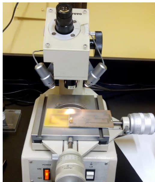
Figura 60. Ensamble de componentes de la antena empleando el microscopio.
