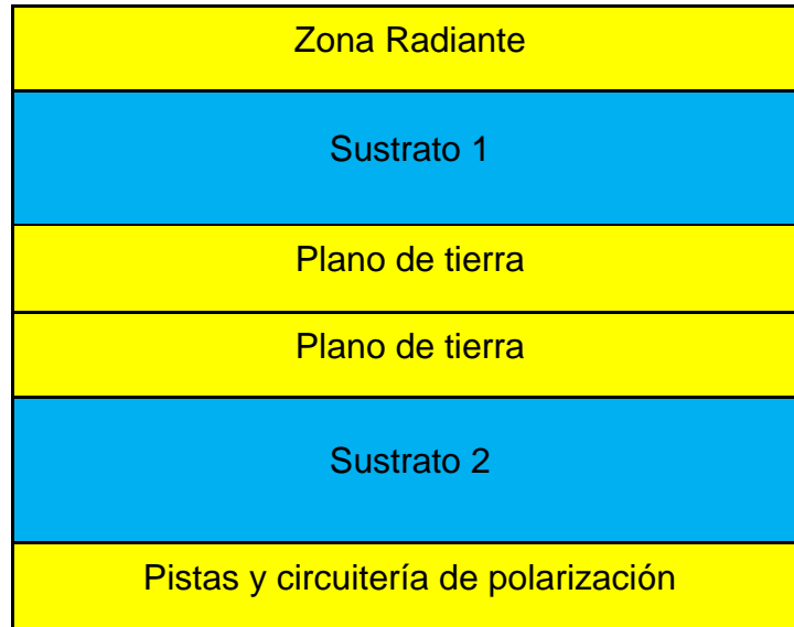
Figura 26. Vista transversal de los substratos de la antena propuesta.
