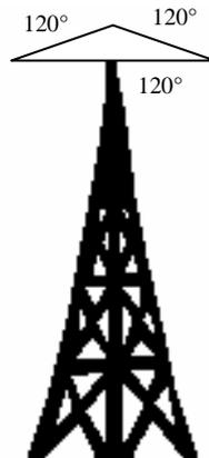
**Figura 47. Disposición triangular para tres arreglos lineales uniformes, donde cada arreglo tiene una cobertura de  $120^\circ$  para lograr cubrir un sector de  $360^\circ$**
