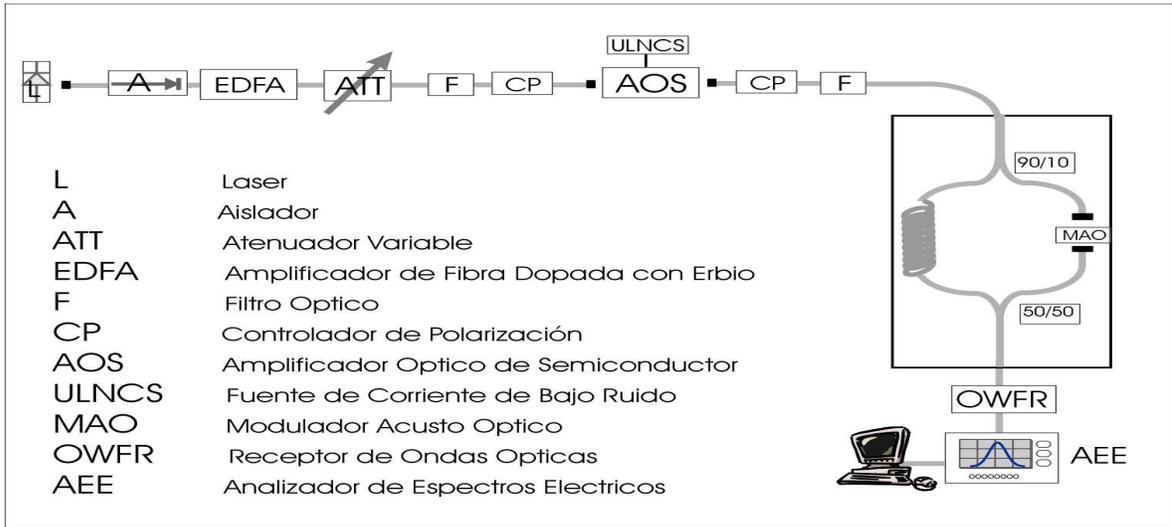
Figura 13 Configuración experimental completa.
