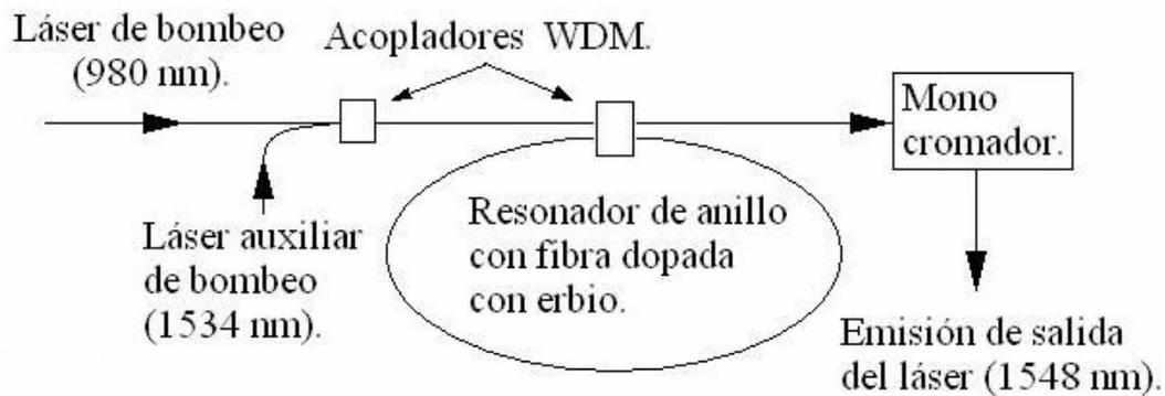
**Figura 28.** LFDE con dos fuentes de bombeo, 980 nm y 1534 nm.
