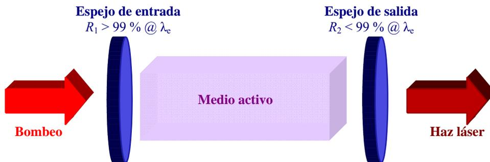
**Figura 3.** Elementos esenciales de un láser.
