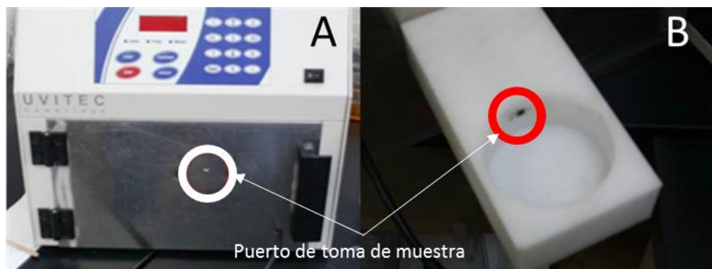
Figura 29. Vistas del fotorreactor, A) exterior e B) interna. En ambas se denota el puerto de toma de muestra.
