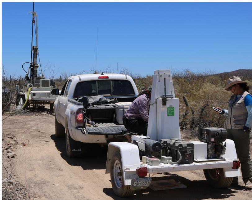
**Figura 16.** Fuente sísmica utilizada para la adquisición de los datos del presente estudio. En la parte inferior de ella se encuentra la placa que cae para golpear el suelo y generar las ondas sísmicas. Al fondo de se aprecia la perforadora.
