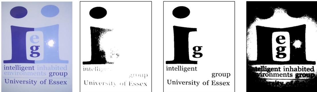
**Figura 38.** Ejemplo de la binarización de una imagen con los valores de umbral 50, 128, 200 (de izquierda a derecha).
