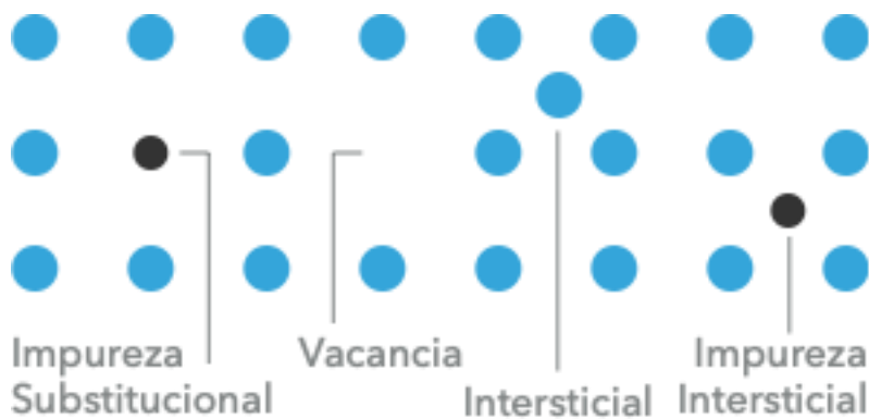
Figura 4. Esquema de una superficie con red cuadrangular con los cuatro defectos puntuales posibles. Los átomos pequeños representan impurezas.
