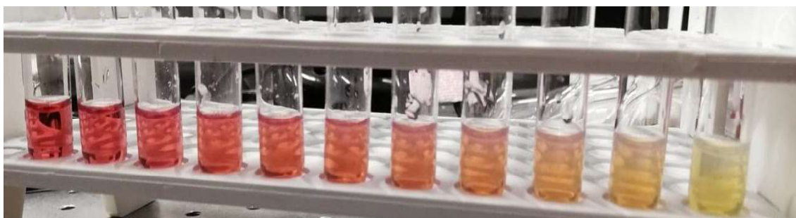
Figura 27. Fotografía de las muestras preparadas a través de mezclas de las suspensiones originales con nanopartículas de oro y plata. La primera muestra de izquierda a derecha representa la muestra que tiene solamente nanopartículas de oro, mientras que la última es la que tiene solamente nanopartículas de plata.
