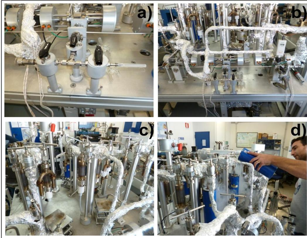
**Figura 24.** Partes esenciales del espectrómetro de masas de gases nobles. **a)** Líneas de extracción del gas. **b)** Líneas de calibración. **c)** Líneas de purificación. **d)** Uso del nitrógeno líquido para evitar la inserción del Ar en la línea del Ne. Laboratorio de gases nobles INGV, Palermo, Italia.
