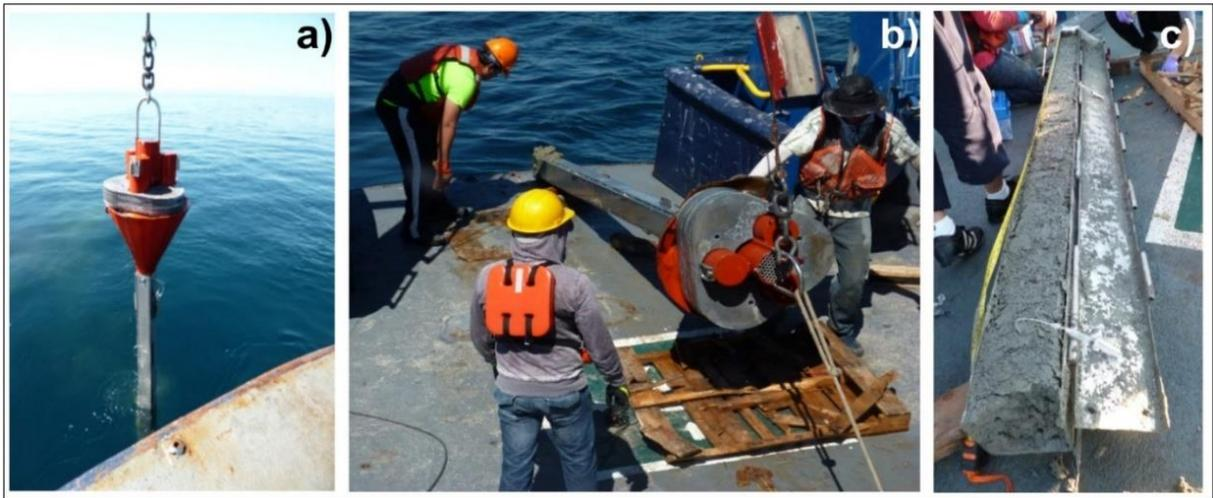
**Figura 17.** Toma de muestras de núcleos de sedimentos marinos. En la foto se observa: **a)** nucleador tipo Kasten, **b)** manipulación de nucleador en cubierta y **c)** muestreo del sedimento.
