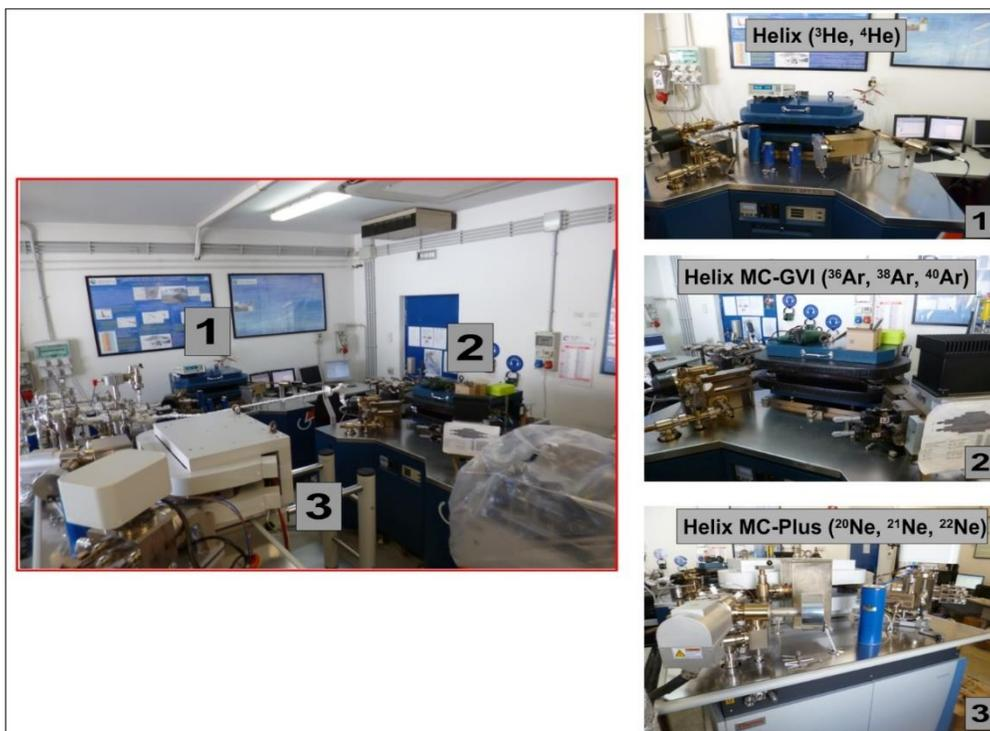
**Figura 23.** Espectrómetro de masas multicolector de gases nobles VG5400 para análisis simultáneo de los gases nobles He-Ne-Ar
