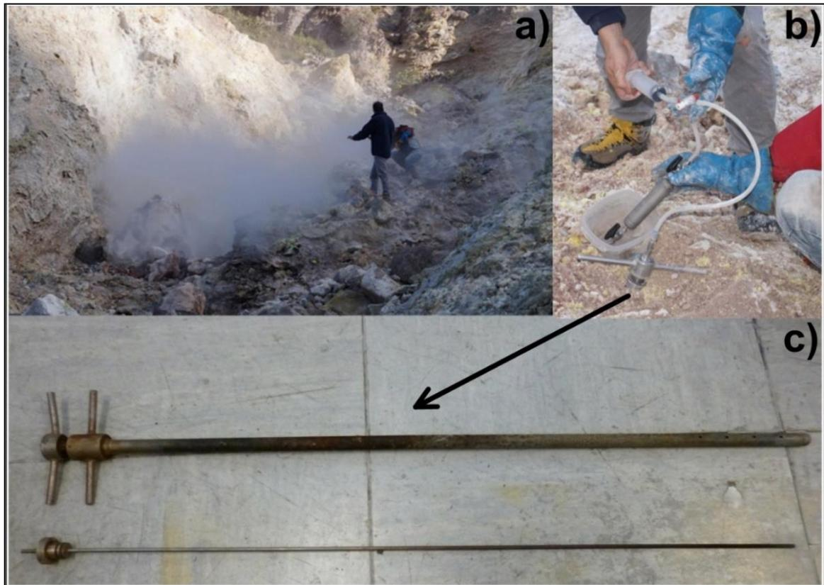
**Figura 12.** Muestreo de fumarolas. **a)** Fumarola cercana al Campo Volcánico Las Tres Vírgenes. **b)** Muestreo de gases fumarólicos con tubo de acero inoxidable. **c)** Partes del tubo de acero.
