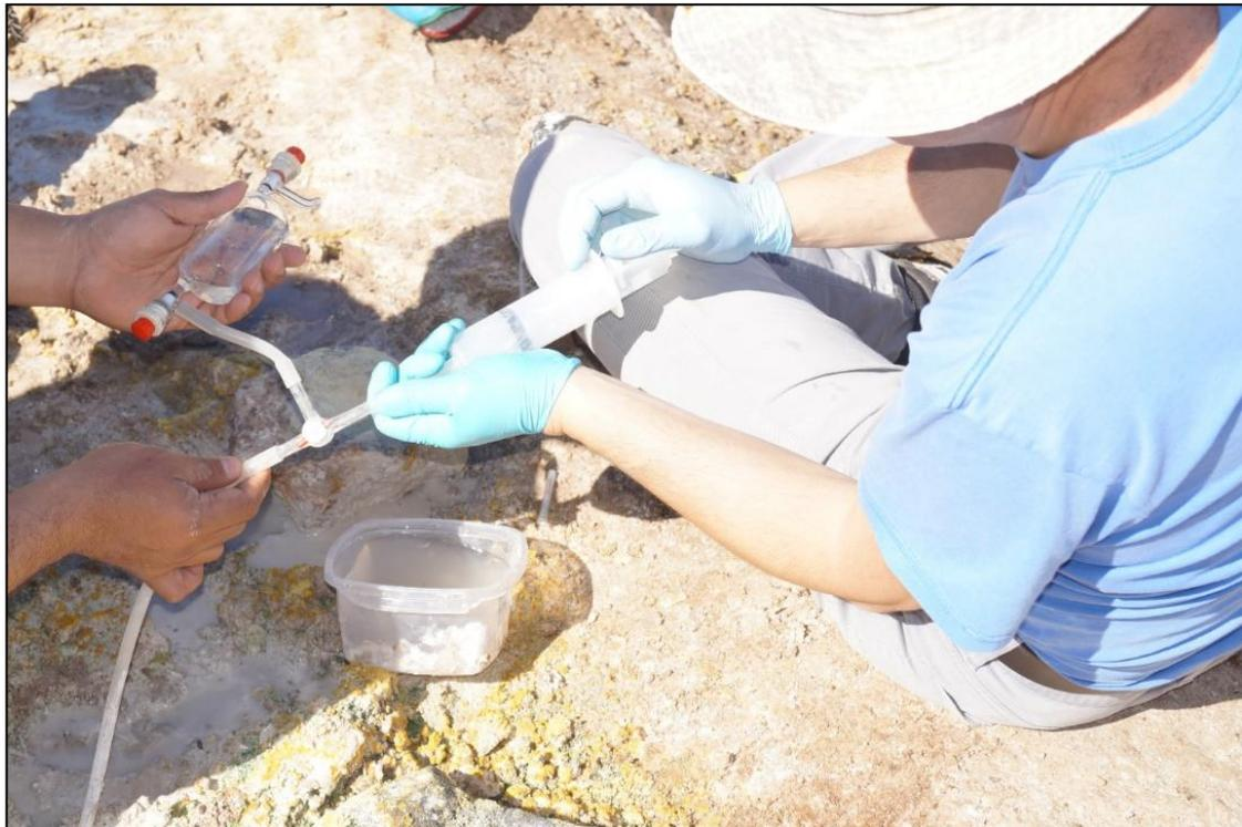
**Figura 13.** Muestreo de sitios “CO<sub>2</sub> dominantes” mediante el uso de la Botella de Giggenbach de doble brazo con solución de NaOH al 4N.
