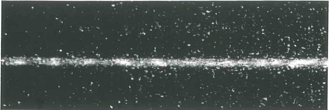
**FIGURA 36** Se muestra la imagen de una parte de una guía que tiene aproximadamente 375 micrómetros de longitud, esta imagen corresponde a una guía de 4 micrómetros de ancho aproximadamente.
