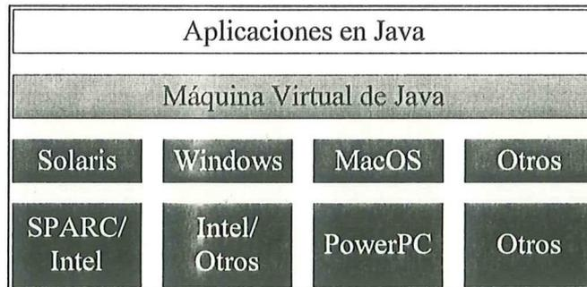
***Figura 14.- La JVM se sitúa entre un sistema operativo nativo y una aplicación en Java, permitiendo que un sólo ejecutable pueda ejecutarse en varios sistemas.***
