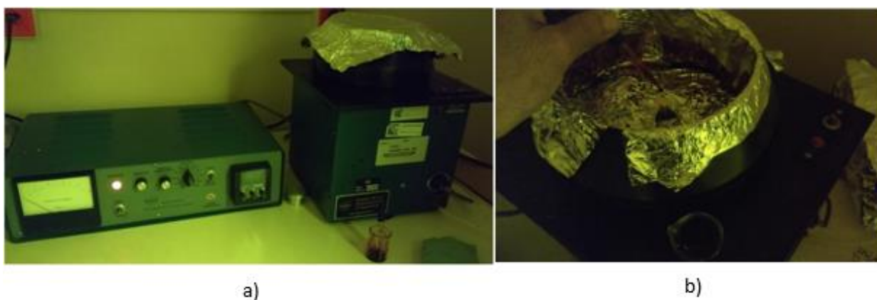
Figura 99. a) Máquina centrífuga SSEC y b) depósito de fotoresina a una de las muestras.
