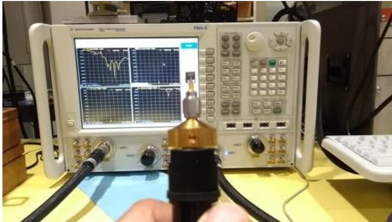
Figura 106. Antena T asimétrica conectada al analizador de redes vectorial N5245A PNA-X de Keysight para la medición del parámetro S_{11} (se utilizó esta misma configuración para medir las antenas de parche circular y parche cuadrado).
