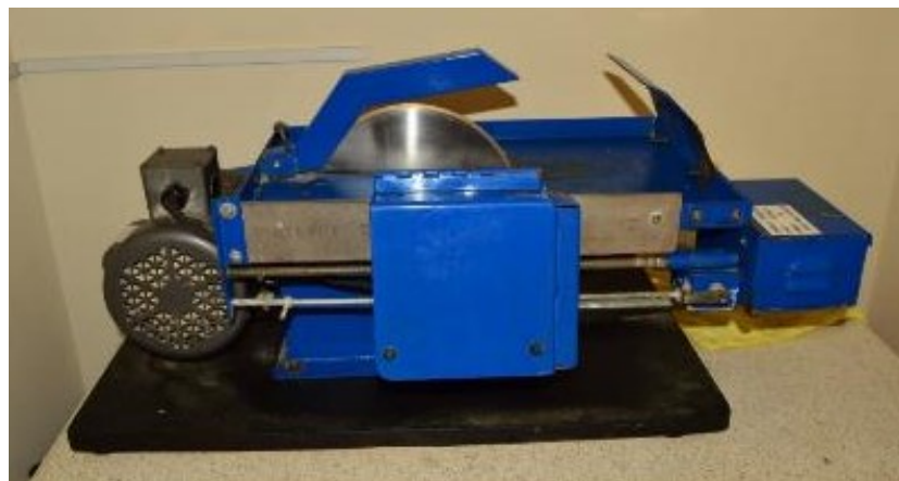
Figura 6. Cortadora de alta velocidad con disco de punta de diamante; marca Barranca Diamond, modelo 8300036.
