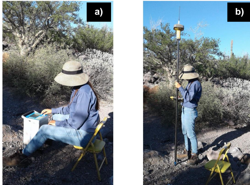
Figura 36. Equipos de medición de datos gravimétricos. a) Gravímetro: Scintrex Autograv CG-5. b) Equipo GPS: Topcon GR-5.
