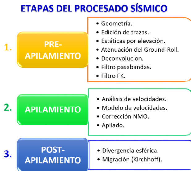
Figura 23. Secuencia del procesado de sismica de reflexión. Propuesto por Yilmaz (2001).
