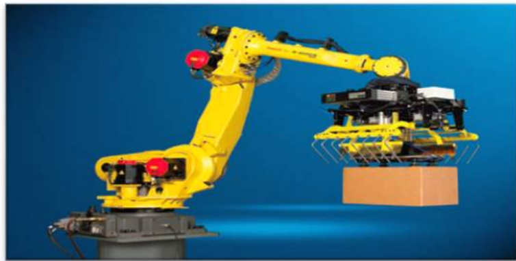
Figura 1. Un robot manipulador es un ejemplo del tipo de sistemas que se encuentran en la capa física de un CPS.
