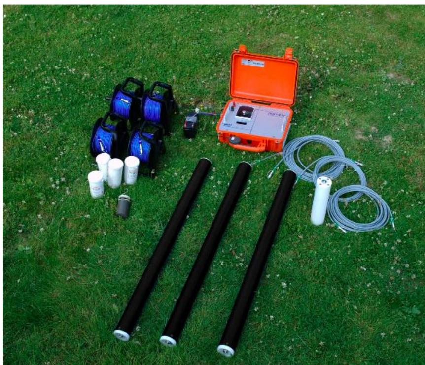
**Figura 22.** Equipo utilizado para el registro de las series de tiempo de los datos magnetotelúricos (MT). Consola ADU07, bobinas de inducción y electrodos no polarizables.
