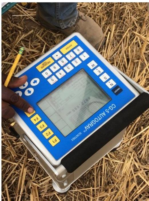
Figura 28. Gravímetro marca Scintrex modelo CG-5.
