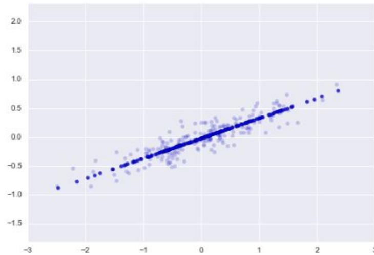
Figura 19. En azul fuerte se encuentran los datos proyectados sobre un solo eje principal. Reduciéndose los datos de 2 dimensiones a una sola.
