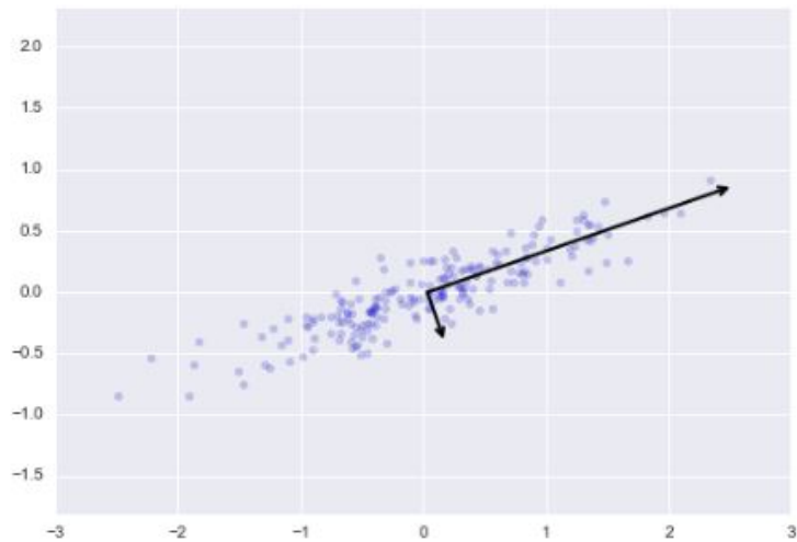
Figura 18. Las flechas negras son los ejes principales de los datos. La longitud de estas es una medida de la varianza de los datos cuando son proyectados en el eje correspondiente.
