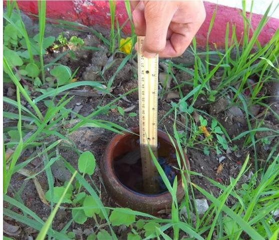
**Figura 9.** Medición del nivel de agua (cm) para determinar el volumen de agua contenido en la olla de barro.
