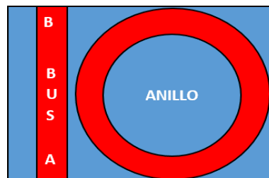
Figura 13. Diagrama esquemático del Resonador de anillo, las letras “A” y “B” que se encuentran en el diagrama son respectivamente la entrada y salida de luz en nuestro dispositivo.
